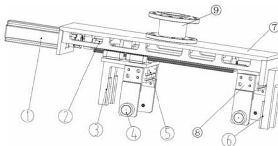
1. 一种电芯模组伺服抓手,包括伺服电机(1)、滚珠丝杆(2)、固定夹爪(6)和支架(7),其特征在于:所述支架(7)下端两侧分别连接伺服电机(1)和固定夹爪(6),所述支架(7)下端靠近固定夹爪(6)一侧设有第一对中气缸(8),所述伺服电机(1)与滚珠丝杆(2)连接、通过伺服电机(1)带动滚珠丝杆(2)的螺杆转动,所述滚珠丝杆(2)上的滑块与移动夹爪(3)和第二对中气缸(5)连接、通过螺杆转动带动移动夹爪(3)和第二对中气缸(5)沿螺杆直线移动,所述第一、二对中气缸(8、5)下端两侧分别设有吸盘(4)、用于吸取电芯模组的侧板,所述支架(7)上端设有抓取盘(9),用于机器人抓取移动电芯模组伺服抓手,所述固定夹爪(6)与支架(7)通过焊接连接。
